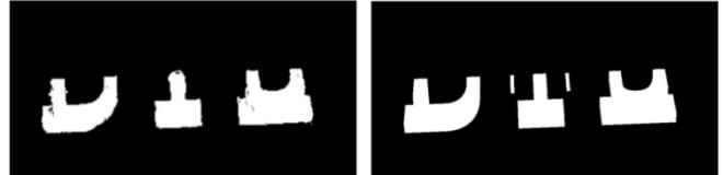
Рис. 5. Результат сегментації реального зображення виробу (зліва) та комп'ютерної моделі (справа)
