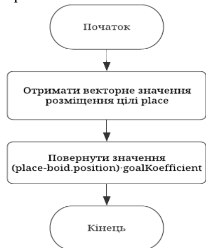
Рис. 10. Схема функції направлення боїду до конкретної цілі
