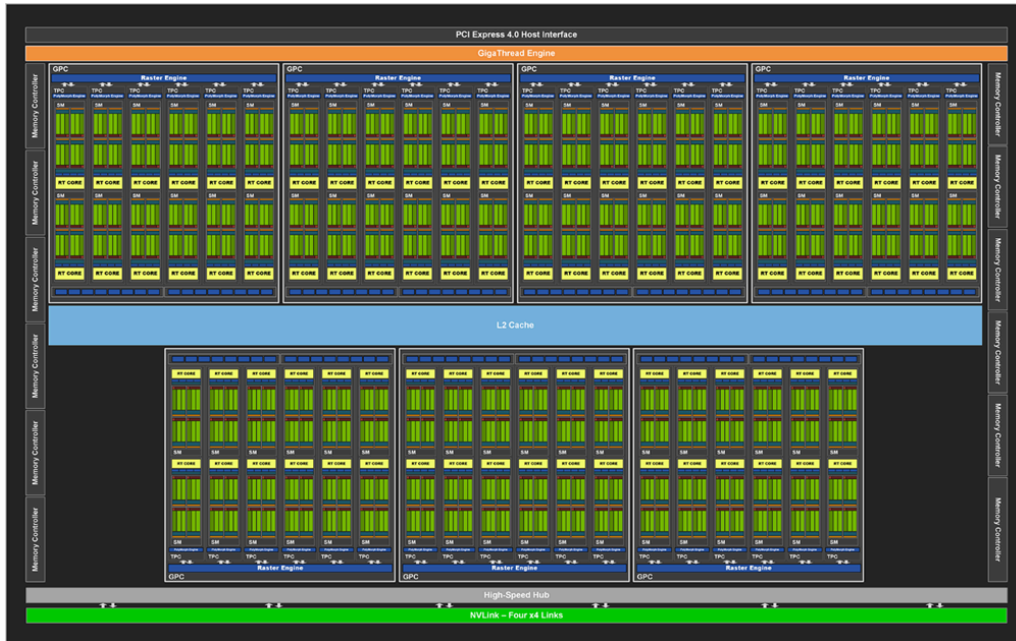
Рисунок 2 – архітектура Ampere для відеокарти GeForce GTX 3080
